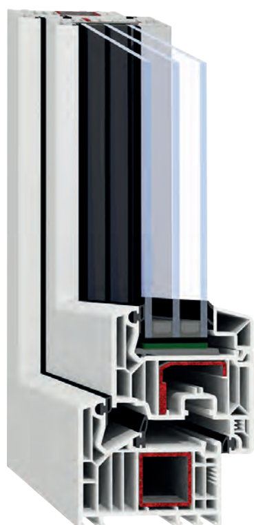
◀ Supertherm 82 MD mit drei umlaufenden Dichtungsebenen und einem Uf-Wert bis 1,0 W/m 2 K.
